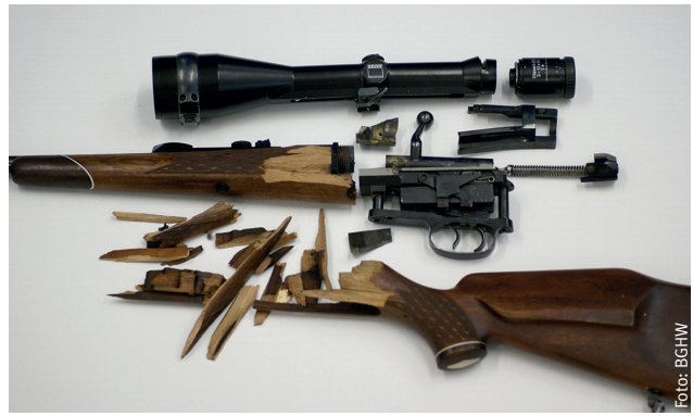
Diese Waffe wurde durch die Verwendung ungeeigneter Munition beschädigt
