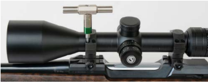
Drehmomentschlüssel sorgen für gleichmäßig fest angezogene Schrauben, ohne dass etwas beschädigt wird.
