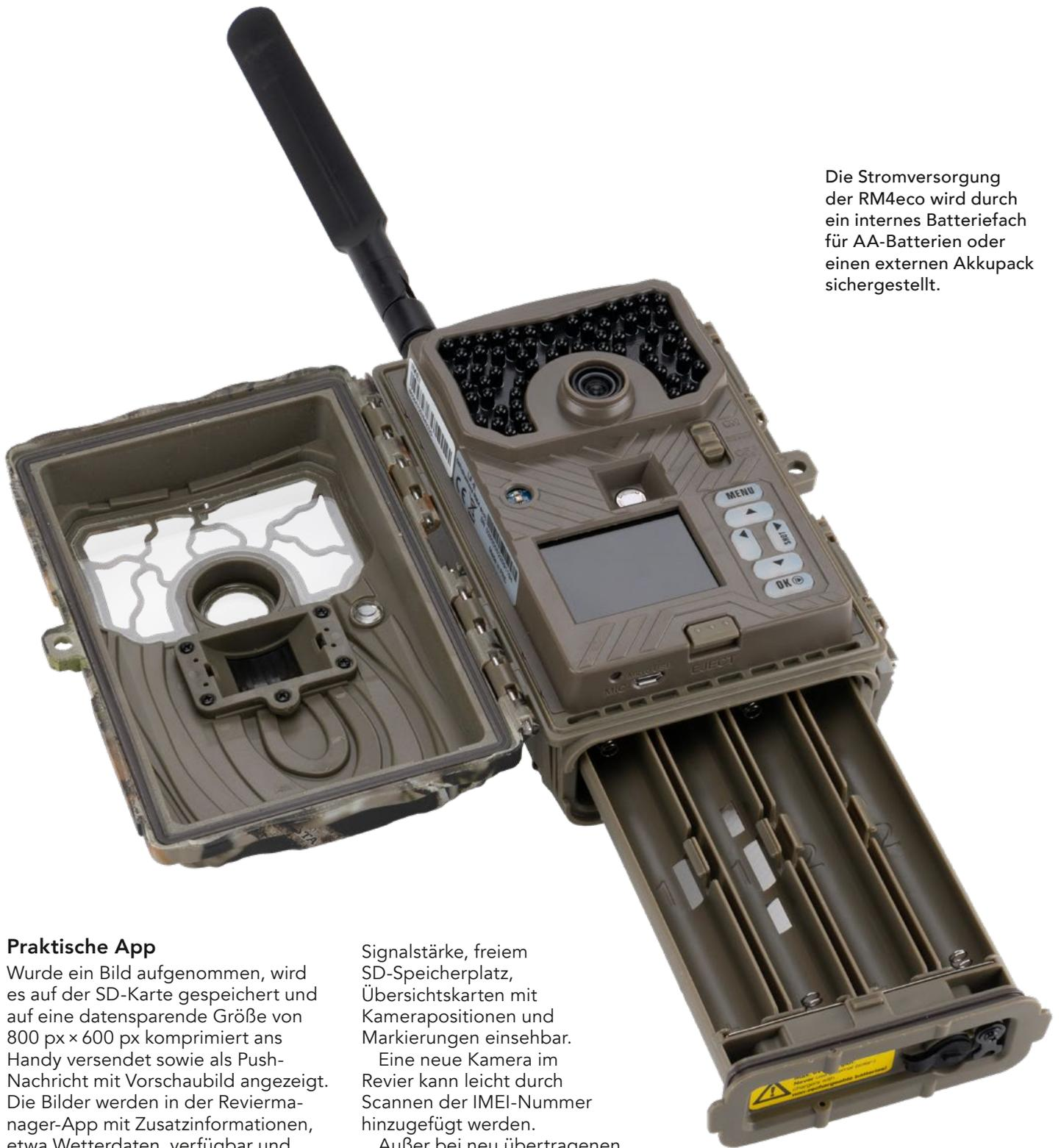
Die Stromversorgung der RM4eco wird durch ein internes Batteriefach für AA-Batterien oder einen externen Akkupack sichergestellt.
