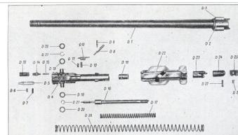
MG 34, Einzelteile: Lauf mit Verschluss
