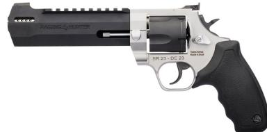
Der Raging Hunter im Kaliber .454 Casull hat eine Trommelkapazität von fünf Schuss. Für ein Plus an Stabilität sorgt die doppelte Trommelverriegelung. Die Waffe verfügt über einen Laufmantel mit Picatinny-Profil (Mil-STD-1913) zur einfachen Montage einer Zielloptik. Der Lauf ist werkseitig mit einem Kompensator ausgestattet der merklich zur Reduzierung des Mündungshochschlags beiträgt. Ein Detail das bei diesem Kaliber sicherlich nicht von Nachteil ist!
