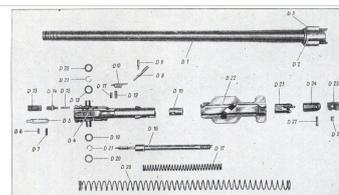
MG 34, Einzelteile: Lauf mit Verschluss
