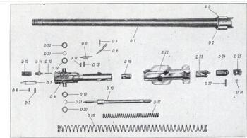
MG 34, Einzelteile: Lauf mit Verschluss
