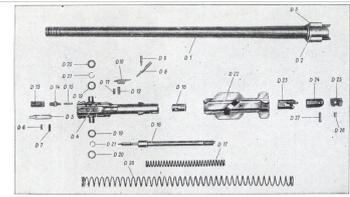
MG 34, Einzelteile: Lauf mit Verschluss
