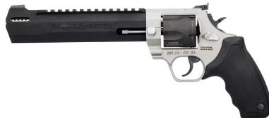
Der Raging Hunter im Kaliber .454 Casull hat eine Trommelkapazität von fünf Schuss. Für ein Plus an Stabilität sorgt die doppelte Trommelverriegelung. Die Waffe verfügt über einen Laufmantel mit Picatinny-Profil (Mil-STD-1913) zur einfachen Montage einer Zielloptik. Der Lauf ist werkseitig mit einem Kompensator ausgestattet der merklich zur Reduzierung des Mündungshochschlags beiträgt. Ein Detail das bei diesem Kaliber sicherlich nicht von Nachteil ist!
