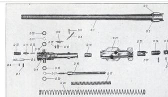
MG 34, Einzelteile: Lauf mit Verschluss
