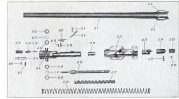
MG 34, Einzelteile: Lauf mit Verschluss
